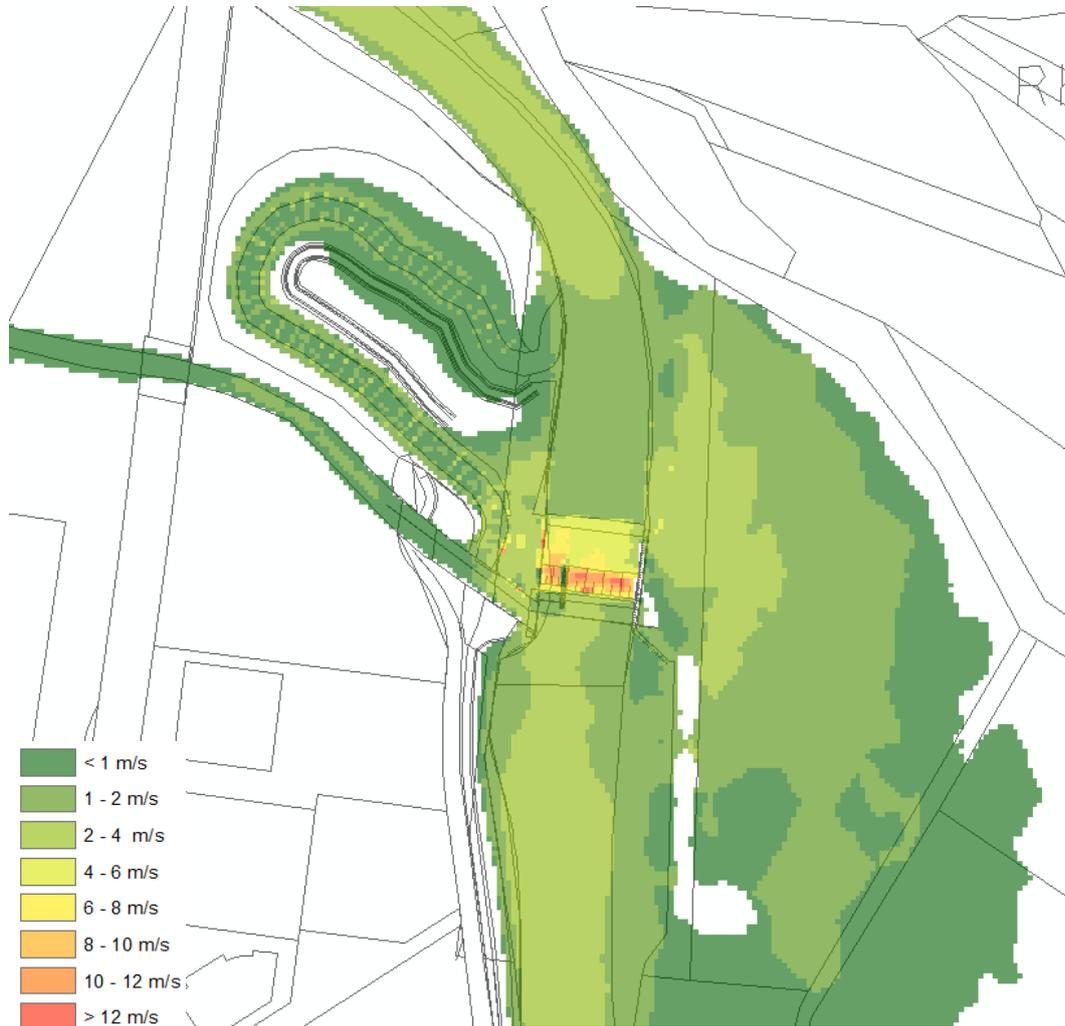
Abbildung 2-7: Fließgeschwindigkeiten für den Planzustand im Bereich der Fischaufstiegsanlage, HQ100
